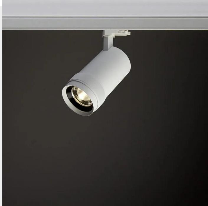
Le Zumo 100 Vario est un projecteur LED zoomable pour les rails de tension de ligne standard.. Le spot est doté d'une LED haute puissance avec un indice de rendu des couleurs élevé (CRI> 97). Le faisceau lumineux peut être réglé à l'infini, du spot de 12° au faisceau large de 55°, en tournant simplement la lentille de zoom. Les projecteurs Zumo 100 Vario sont particulièrement adaptés à l'éclairage des galeries, des musées et des expositions d'art.
