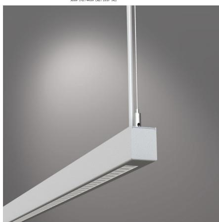
Evolo-S white est un luminaire suspendu LED élégant et fin équipé d'une rangée de LED mid-power, chacune avec une lentille et un déflecteur individuels. Le luminaire crée une distribution lumineuse à faible éblouissement ce qui le rend adapté aux environnements de bureau. Le luminaire est fabriqué en acier et fini avec un revêtement poudre décoratif structuré blanc mat.
