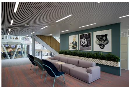
Fusion-SAPP, un luminaire linéaire avec une lentille prismatique ou un diffuseur opale pour une utilisation dans les plafonds Interalu SAPP®. Ce luminaire LED a été développé comme alternative aux luminaires fluorescents linéaires T5 pour une utilisation dans les projets de rénovation et de construction neuve.
