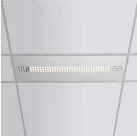
Myos-M Multioptic Linear est une gamme de luminaires encastrés innovants avec des modules LED de puissance moyenne qui utilisent la technologie de lentilles Multioptic®, spécialement conçus pour une utilisation en combinaison avec des plafonds modulaires apparents. Le système optique contient un réseau de lentilles de 99 LED de puissance moyenne derrière un masque de diaphragme décoratif.
