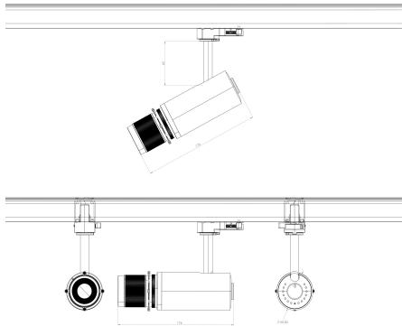
Le spot Zumo Contour est un spot LED avec projecteur de contour, adapté aux systèmes de rails 3 circuits standard. Le spot dispose d'une LED puissante avec un indice de rendu des couleurs élevé (IRC> 97).
