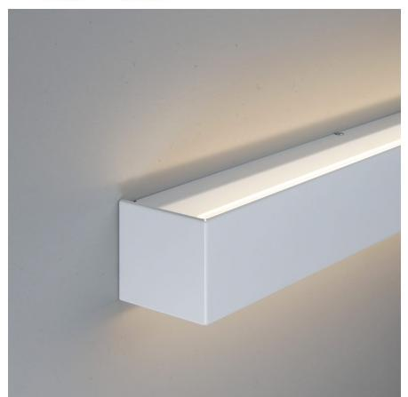
Zenders, un luminaire LED mural, est conçu pour l'éclairage architectural intérieur de surfaces verticales, telles que les murs, couloirs et escaliers. La lumière émise par une bande LED montée en interne en direction du mur est d'abord diffusée par un double diffuseur satiné puis réfléchie vers le haut et vers le bas, créant un mur doucement éclairé.
