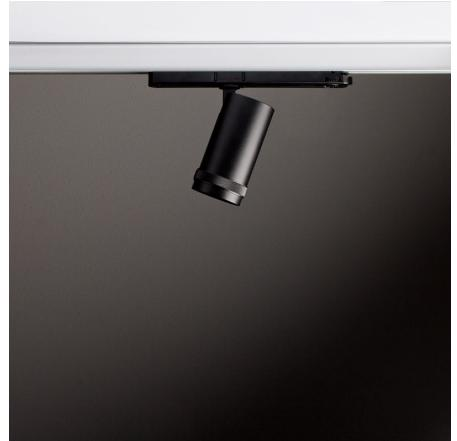
Zumo 60 Vario est un spot LED zoomable pour rails triphasés standard. Le spot est équipé d'une LED puissante avec un indice de rendu des couleurs élevé (IRC > 97). Le faisceau lumineux peut être réglé en continu de 10° (spot) à 50° (large flood) en tournant simplement la lentille zoom. Les spots Zumo 60 Vario sont particulièrement adaptés à l'éclairage de galeries, de musées et d'expositions d'art.
