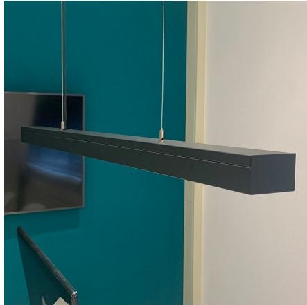
Fusion-S2 noir est un luminaire suspendu LED architectural pour un éclairage de travail élégant et efficace des espaces de travail. La chambre d'éclairage est protégée par une lentille microprismatique qui assure une faible luminance de surface (UGR< 19) pour un éclairage de travail uniforme et confortable.
